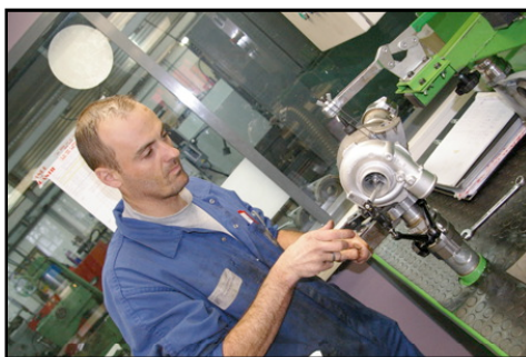
Turbo à géométrie variable en cours de réglage sur un banc conçu spécialement.
