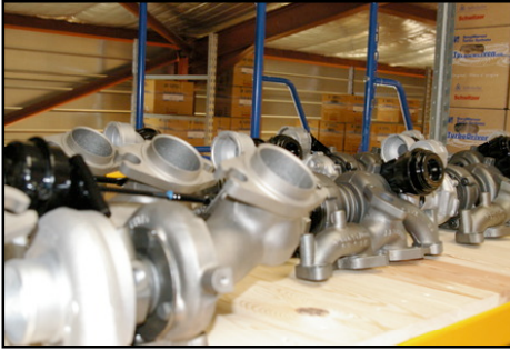
Exemple de turbos rénovés à géométrie variable, ici le Volkswagen TDI, 140 ch
