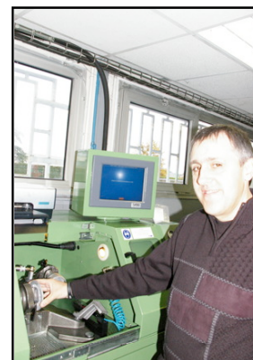
Banc VSR pour le contrôle d'étanchéité phonique et vibratoire de l'ensemble tournant.
